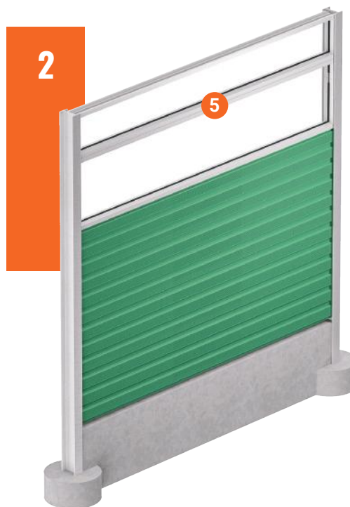
Przęsło mieszane / Mixed span / Gemischter Abschnitt
